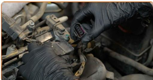
**8** Konektor cívky zapalování ošetřete pomocí spreje na elektroniku. Sprej ochrání elektrické kontakty před korozí, oxidací, a sníží odpor kontaktů.
