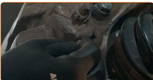
**33** Nainstalujte zádržnou pružinu brzdového třmenu. Použijte páčidlo.
