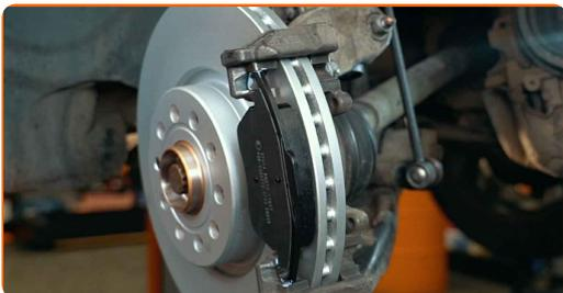
**31** Nainstalujte brzdový třmen a upevněte jej. Použijte imbusový klíč č. H7. Použijte momentový klíč. Utáhněte ji točivým momentem 30 Nm.
