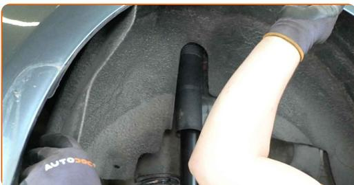
**42** Zašroubujte upevňovací prvky vložky podběhu kola. Použijte hvězdicový Torx T 25. Použijte ráčnový klíč.
