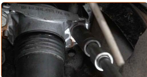
**37** Natřete upevňovací prvky uložení tlumiče. Použijte měděné mazivo.
