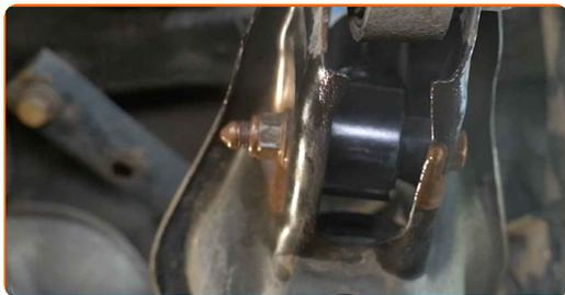
**46** Vyčistěte montážní otvor disku kola. Použijte drátěný kartáč.
