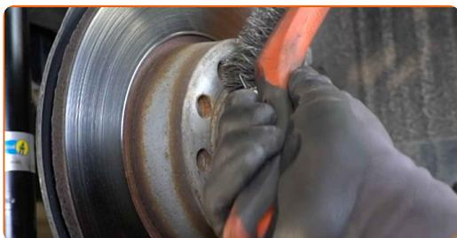
**47** Natřete povrch, kde je brzdový kotouč v kontaktu s ráfem kola. Použijte keramické mazivo.
