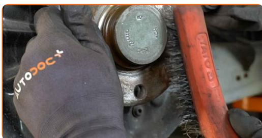
**22** Natřete kontaktní povrch. Použijte keramické mazivo.
