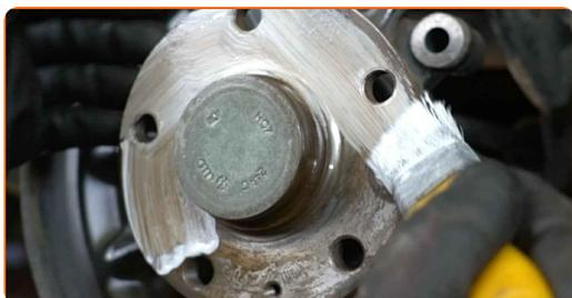
**23** Nainstalujte brzdový kotouč.
