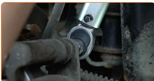
**36** Natřete povrch, kde je brzdový kotouč v kontaktu s ráfem kola. Použijte keramické mazivo.
