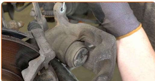
Výměna: brzdového kotouče - SEAT Leon Van / Hatchback (5F1). Tip:
