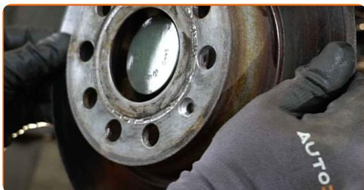
**21** Vyčistěte náboj. Použijte drátěný kartáč. Použijte víceúčelový čisticí sprej.
