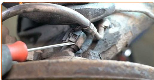
**8** Odšroubujte upevnění ABS snímače. Použijte imbusový klíč č. H5. Použijte ráčnový klíč.
