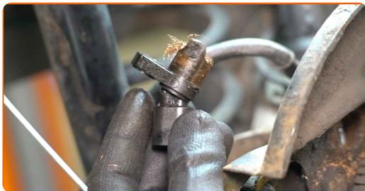
**17** Vyčistěte montážní pozici ABS senzoru. Použijte drátěný kartáč. Použijte sprej WD-40.
