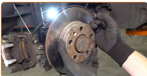
**16** Odpojte snímač ABS. Použijte průbojník. Použijte kladivo. Použijte páčidlo.
