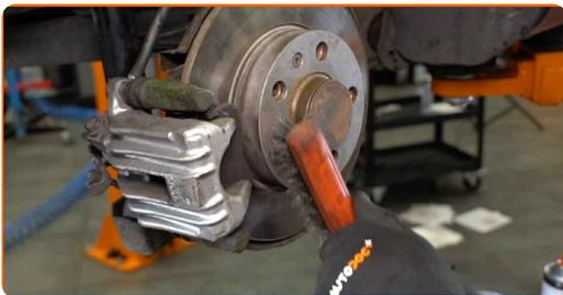
**30** Natřete povrch, kde je brzdový kotouč v kontaktu s ráfem kola. Použijte měděné mazivo.
