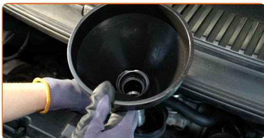
**25** Nalijte olej do motoru přes plnicí hrdlo. Potřebné množství oleje: 4.3 l.
