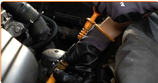
**5** Vyčistěte uzávěr krytu olejového filtru. Použijte víceúčelový čisticí sprej.
