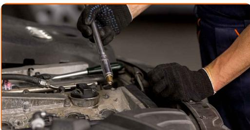
**10** Aplikujte tenkou vrstvou speciálního vysokoteplotního maziva proti zadření na závity nových svíček zapalování.
