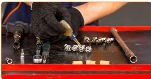
**11** Nainstalujte nové svíčky zapalování do otvorů pro jejich montáž. Použijte klíč na svíčky zapalování č. 16.
