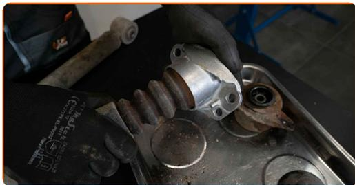
**17** Nainstalujte nové ložisko tlumiče.
