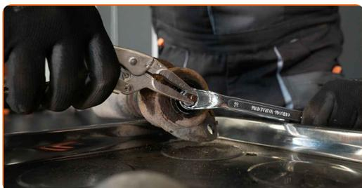
**15** Odstraňte uložení tlumiče, návlek a tlumící doraz.
