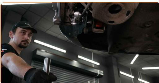
**25** Vyčistěte montážní otvor disku kola. Použijte drátěný kartáč. Natřete kontaktní povrch. Použijte měděné mazivo.
