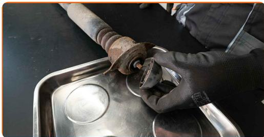
**13** Vyčistěte upevňovací prvek tyčky tlumiče. Použijte drátěný kartáč. Použijte sprej WD-40.
