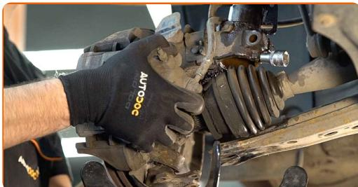
Výměna: uložení tlumiče - SKODA Fabia II Hatchback (542). Doporučují odborníci z AUTODOC:
