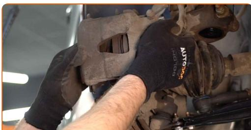
Výměna: brzdového kotouče - SKODA Fabia IV Hatchback (PJ3). Doporučují odborníci z AUTODOC:
