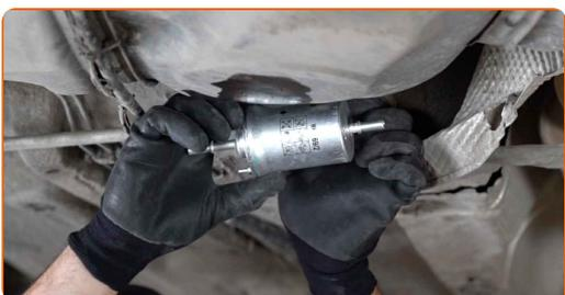
Výměna: palivového filtru - SKODA FABIA limuzína (6Y3). Profesionálové doporučují:
