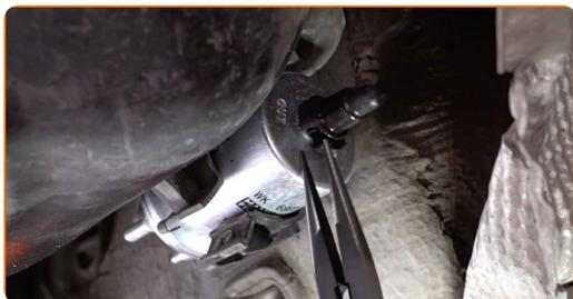
**10** Utáhněte upevňovací prvky palivového filtru. Použijte křížový šroubovák PH.
