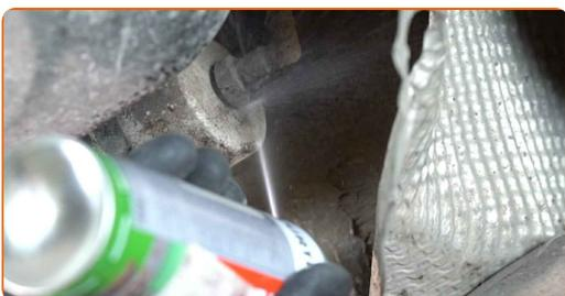
**4** Uvolněte upevnění palivového filtru. Použijte křížový šroubovák PH.
