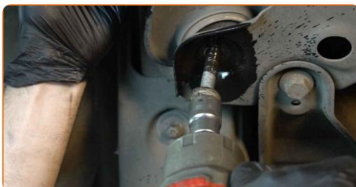
**10** Odšroubujte upevňovací prvek spojující kulový čep a ovládací rameno odpružení. Použijte nástavec č.16. Použijte vratidlo.
