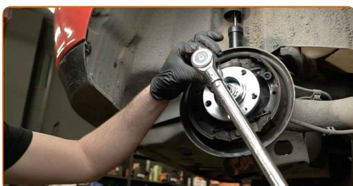
Výměna: ložiska kola - SKODA FABIA (NJ3). Profesionálové doporučují:
