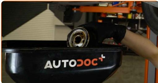
Výměna: motorového oleje a filtru - SKODA Felicia Cube Van (6U5). Tip od AUTODOC:
