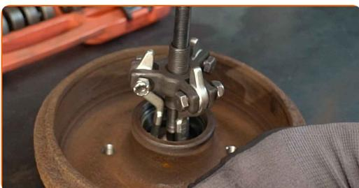
**19** Odstraňte vnitřní drážku ložiska kola z brzdového bubnu. Použijte sadu vložky a ořechu ložiska.
