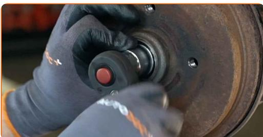
**12** Odstraňte brzdový buben sestavený s ložiskem náboje kola.
