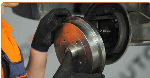
Výměna: brzdové čelisti - SKODA Felicia I Pick-up (6UF, 6U7). Tip:
