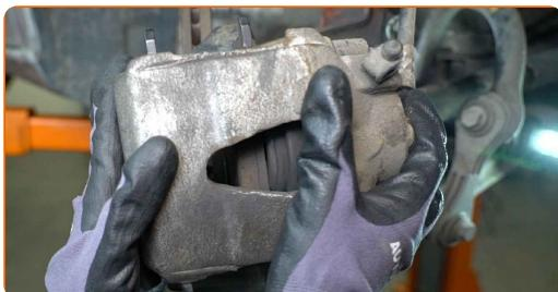
Výměna: brzdového kotouče - SKODA Octavia I Combi (1U5). AUTODOC doporučuje:
