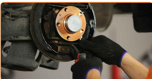
**22** Vložte vodící pružiny do příslušných otvorů. Použijte kleště.
