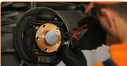
**23** Vyčistěte náboj. Použijte drátěný kartáč. Natřete kontaktní povrch. Použijte měděné mazivo.
