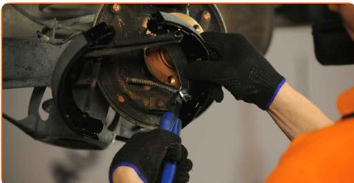
**20** Nainstalujte brzdové čelisti na pracovní brzdový válec, na svorku podpůrného kotouče brzdy.
