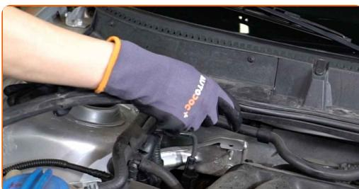
4 Odšroubujte upevňovací prvky plastového panelu. Použijte křížový šroubovák PH.
