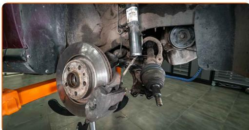
Výměna: uložení tlumiče - SKODA Octavia I Combi (1U5). Tip:
