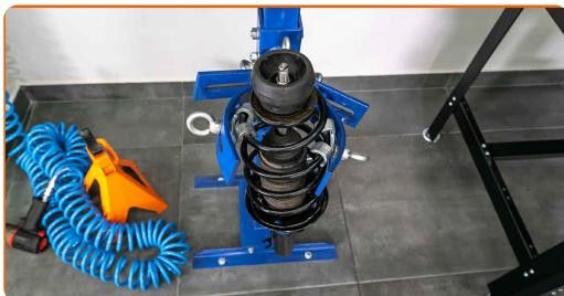
Výměna: uložení tlumiče - SKODA Octavia I Combi (1U5). Doporučují odborníci z AUTODOC:
