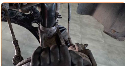
Výměna: uložení tlumiče - SKODA Octavia I Combi (1U5). Tip od AUTODOC:
