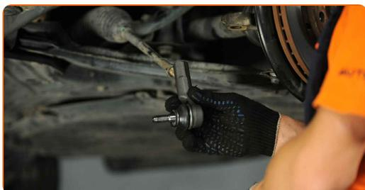
Výměna: kulového čepu řízení - SKODA Octavia I Combi (1U5). Tip od odborníků z AUTODOC:
