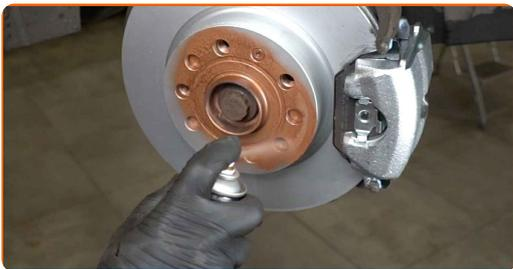
20 Vyčistěte povrch brzdového kotouče. Použijte čistič brzd.
