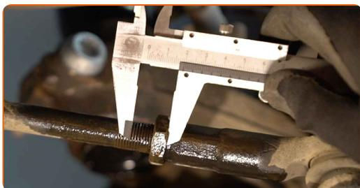
7 Vyčistěte pojistnou matici, která spojuje táhlo řízení k čepu táhla řízení. Použijte drátěný kartáč. Použijte sprej WD-40.
