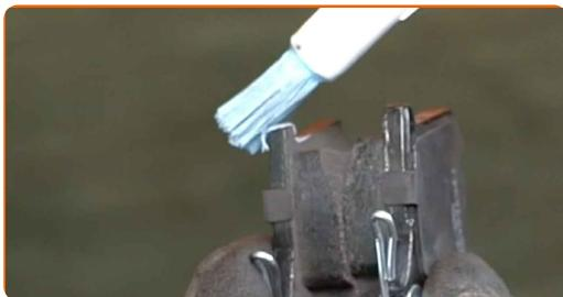
Výměna: brzdové destičky - SKODA Octavia III Hatchback (5E3, NL3, NR3). Tip od AUTODOC:
