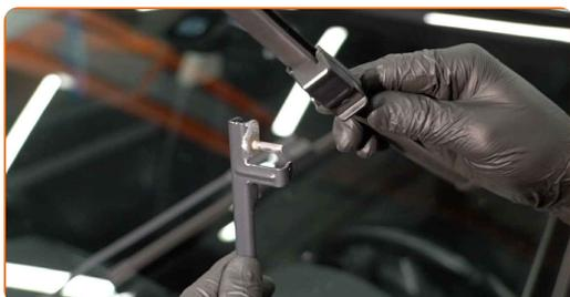
Výměna: stírací lišty - SKODA Octavia III Hatchback (5E3, NL3, NR3). Tip:
