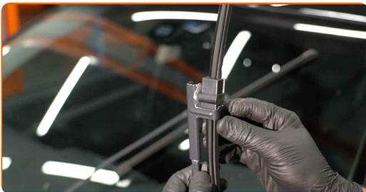
Výměna: stírací lišty - SKODA Octavia III Hatchback (5E3, NL3, NR3). Tip od AUTODOC:
