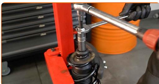
Výměna: pružiny podvozku - SKODA Rapid Spaceback (NH1). Tip od AUTODOC:
