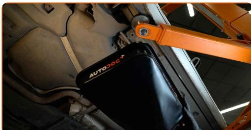
**5** Vyčistěte upevňovací prvky hadiček na dodávku paliva. Použijte nylonový čistící kartáč. Použijte víceúčelový čistící sprej.
