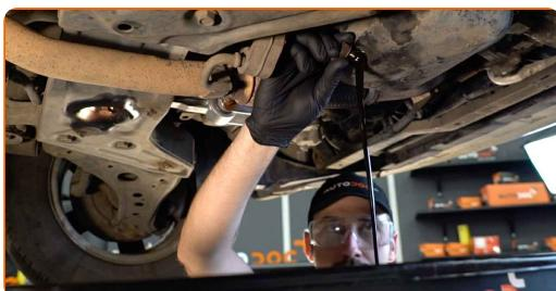
Výměna: motorového oleje a filtru - SKODA ROOMSTER (5J). Profesionálové doporučují:
