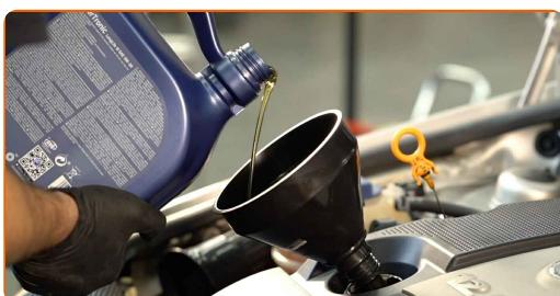
Výměna: motorového oleje a filtru - SKODA ROOMSTER (5J). Doporučují odborníci z AUTODOC:
