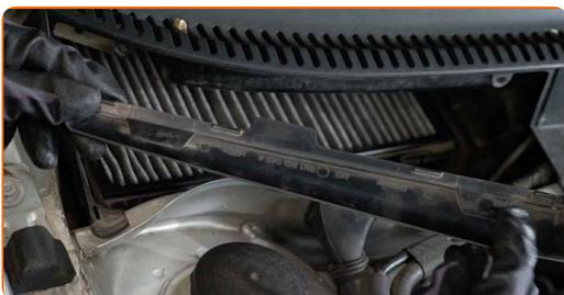
**7** Zatlačte na držák kabinového filtru, aby se uvolnil.
