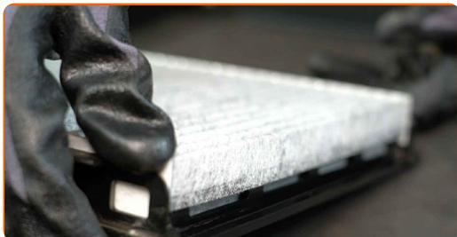
Výměna: kabinového filtru - SKODA SUPERB (3U4). AUTODOC doporučuje:
