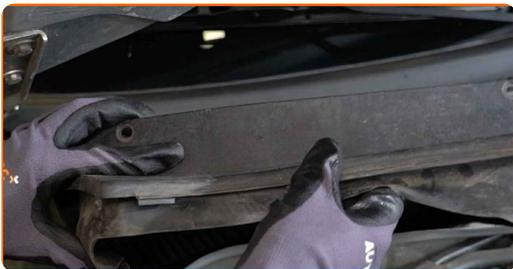
**6** Odstraňte kryt uložení kabinového filtru.
