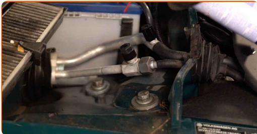
6 Uvolněte vrchní upevňovací prvek ložiska vzpěry tlumiče. Použijte nástavec č. 16. Použijte ráčnový klíč.
