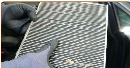
Výměna: kabinového filtru - SKODA SUPERB (3V3). Tip od AUTODOC:
