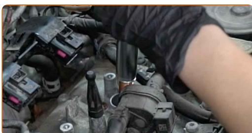
Výměna: zapalovacích svíček - SKODA SUPERB kombík (3V5). Doporučují odborníci z AUTODOC:
