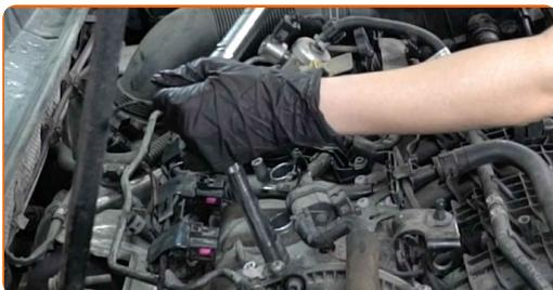
Výměna: zapalovacích svíček - SKODA SUPERB kombík (3V5). AUTODOC doporučuje:
