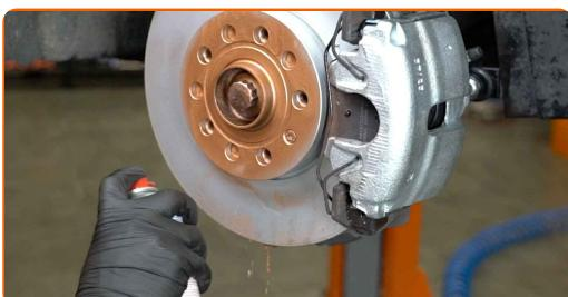
Výměna: brzdového kotouče - SKODA YETI (5L). Tip od odborníků z AUTODOC:
