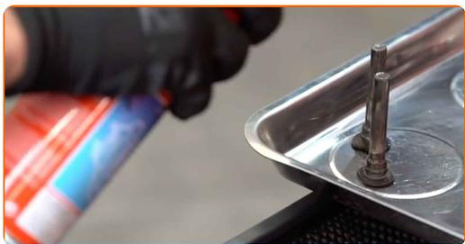
**25** Očistěte vodící závlačky brzdového třmenu.
