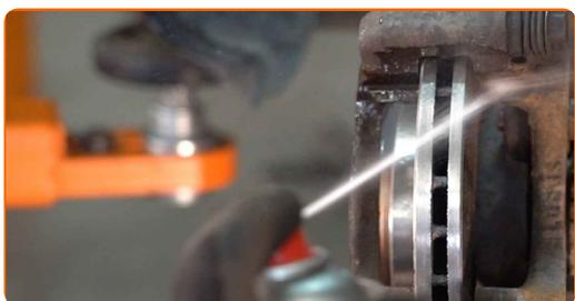
**29** Natřete upeňovací prvky držáku brzdového třmenu. Použijte těsnící materiál.
