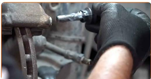
**28** Vyčistěte upeňovací prvky držáku brzdového třmenu. Použijte drátěný kartáč. Použijte sprej WD-40.
