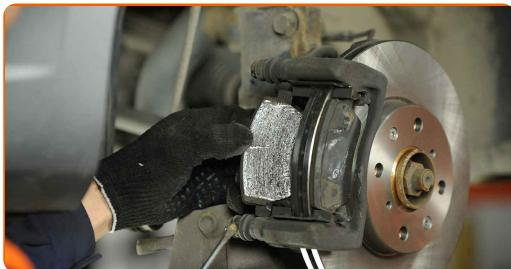
Výměna: brzdové destičky - Suzuki Swift MK3. Doporučují odborníci z AUTODOC:
