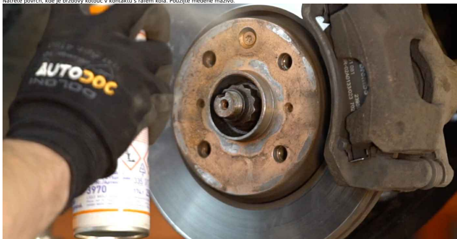
23 Vyčistěte montážní otvor disku kola. Použijte čistič brzd.
