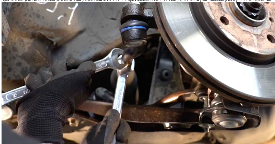
20 Nainstalujte vodící závlačku upevňující táhlo řízení club.autodoc.cz 7-11
