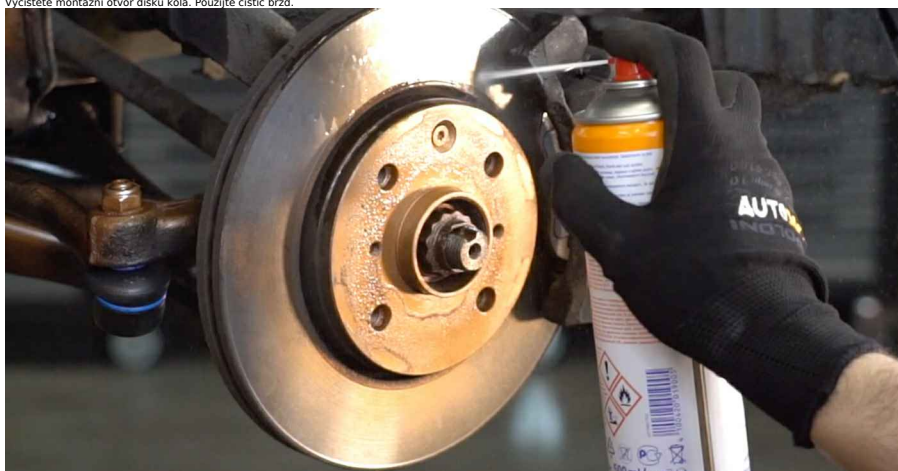
23 Vyčistěte montážní otvor disku kola. Použijte čistič brzd.
