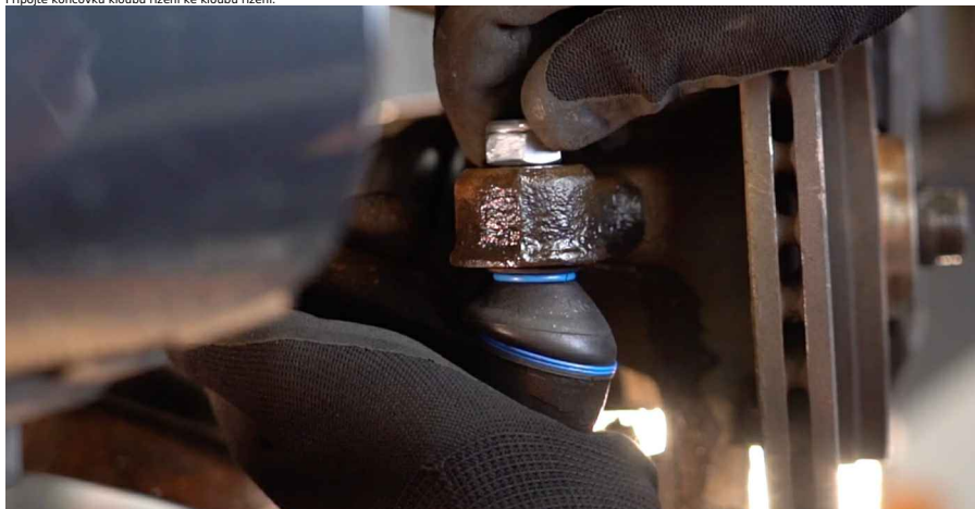
18 Utáhněte upevňovací matici spojující čep táhla řízení k hlavě ložiska čepu kola. Použijte nástavec č.17. Použijte momentový klíč. Utáhněte ji točivým momentem 33 Nm.
