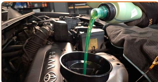
Výměna: motorového oleje a filtru - TOYOTA bB II (QNC2\_). Tip:
