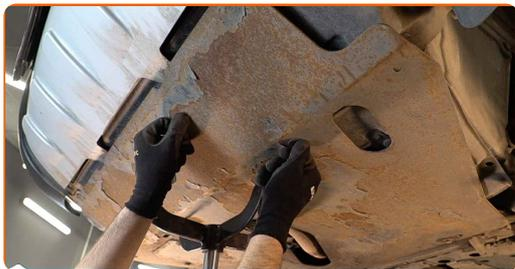
**21** Utáhněte upevnění spodního krytu olejové vany. Použijte nástavec č.12.
