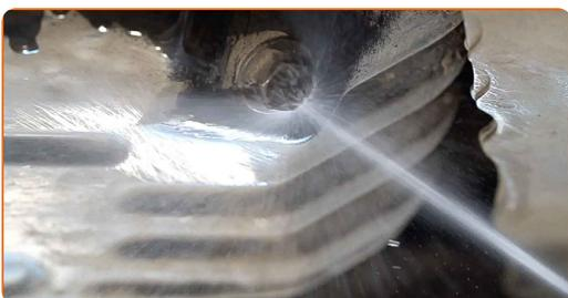
**8** Pod výpustný otvor položte nádobu na vytékající olej o objemu alespoň 5 l.
