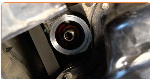
**15** Namažte gumové těsnění nového filtru malým množstvím čerstvého oleje.
