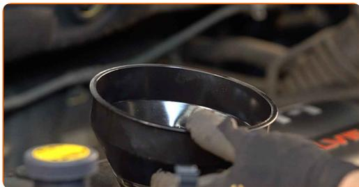
**24** Nový olej nalijte do motoru, a to v množství, které doporučuje výrobce auta.
