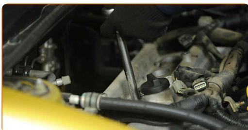
Výměna: zapalovacích svíček - TOYOTA COROLLA LEVIN kupé (AE10\_).
