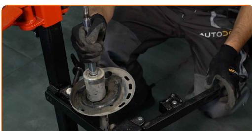
Výměna: pérovací jednotka - TOYOTA COROLLA limuzína (E15\_).
