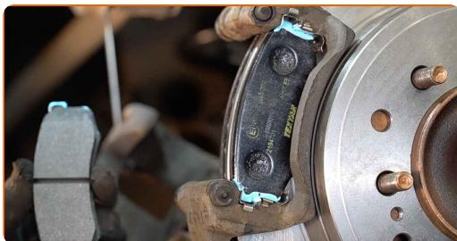
Výměna: brzdové destičky - TOYOTA HILUX III pick-up (TGN1\_, GGN2\_, GGN1\_, KUN2\_, KUN1\_). Tip od odborníků z AUTODOC:
