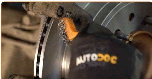
Výměna: brzdové destičky - TOYOTA HILUX III pick-up (TGN1\_, GGN2\_, GGN1\_, KUN2\_, KUN1\_). Profesionálové doporučují:
