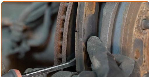
Výměna: brzdové destičky - TOYOTA HILUX III pick-up (TGN1\_, GGN2\_, GGN1\_, KUN2\_, KUN1\_). Tip od AUTODOC:
