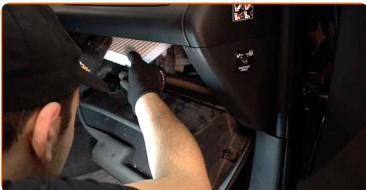
Výměna: kabinového filtru - TOYOTA HILUX III pick-up (TGN1\_, GGN2\_, GGN1\_, KUN2\_, KUN1\_). Tip od odborníků z AUTODOC:
