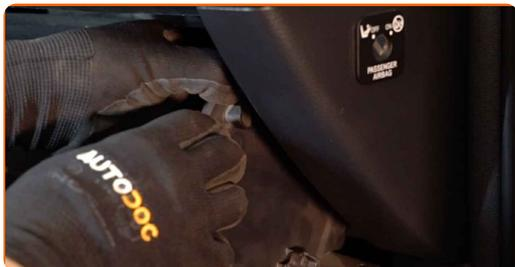
**4** Odstraňte kryt uložení kabinového filtru.
