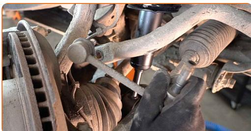
Výměna: tyčky stabilizátoru - TOYOTA HILUX pick-up (GUN1\_). Tip od odborníků z AUTODOC:
