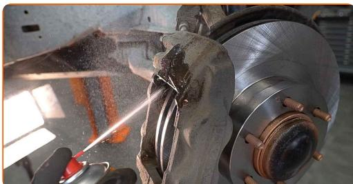
Výměna: brzdové destičky - TOYOTA HILUX pick-up (GUN1\_). Tip:
