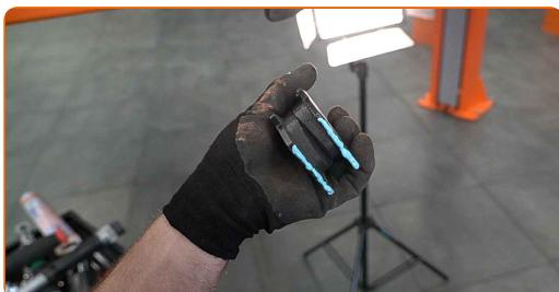
Výměna: brzdové destičky - TOYOTA HILUX pick-up (GUN1\_). Profesionálové doporučují:
