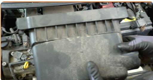
**6** Překryjte přívodní vzduchovou hadičku ručníkem z mikrovlákna, aby se do systému nedostal prach a špína.
