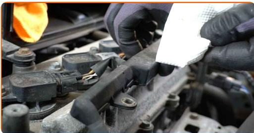
**12** Vložte měrku hladiny oleje.
