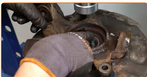
Výměna: ložiska kola - TOYOTA Prius C Hatchback. Doporučují odborníci z AUTODOC:
