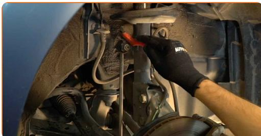
7 Odšroubujte upevnění spojující vzpěru stabilizátoru a stabilizátor. Použijte imbusový klíč č. H6. Použijte kombinační klíč č.17.
