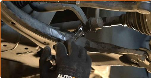
8 Odšroubujte upevnění spojující vzpěru stabilizátoru a vzpěru tlumiče. Použijte kombinační klíč č.17. Použijte nástavec č.17. Použijte ráčnový klíč.
