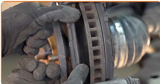
Výměna: brzdové destičky - TOYOTA PRIUS PLUS (ZVW4\_). Doporučují odborníci z AUTODOC:
