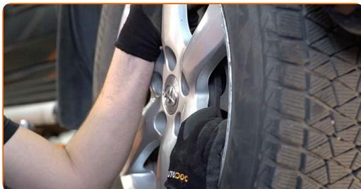
Výměna: brzdové destičky - TOYOTA PRIUS PLUS (ZVW4\_). AUTODOC doporučuje:
