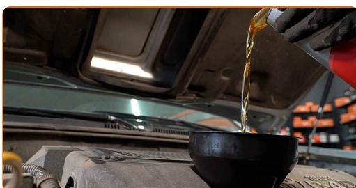
Výměna: motorového oleje a filtru - TOYOTA Sequoia (\_K3\_, \_K4\_). Tip od odborníků z AUTODOC:
