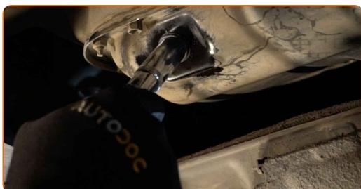
**25** Vyčistěte místo výpustného otvoru olejové vany. Použijte víceúčelový čisticí sprej.
