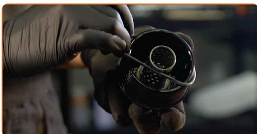
**18** Nainstalujte nový olejový filtr do montážního místa na krytu filtru.
