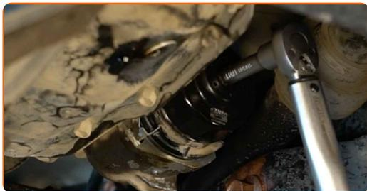
**23** Vyčistěte místo výpustného otvoru olejové vany.
