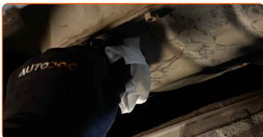
**24** Zašroubujte novou zátku výpustného otvoru a utáhněte ji. Použijte nástavec č.14. Použijte momentový klíč. Utáhněte ji točivým momentem 27 Nm.
