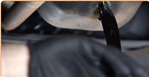
**Výměna: motorového oleje a filtru - TOYOTA Starlet IV Hatchback (P80). Tip od AUTODOC:**
