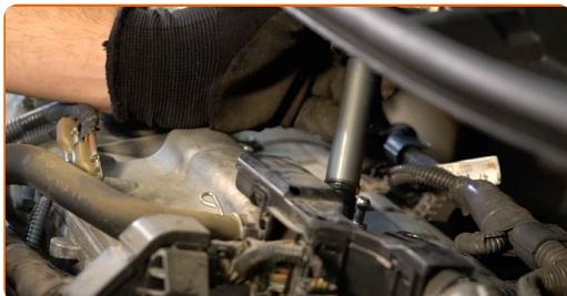
Výměna: zapalovacích svíček - TOYOTA Urban Cruiser (\_P1\_). AUTODOC doporučuje:
