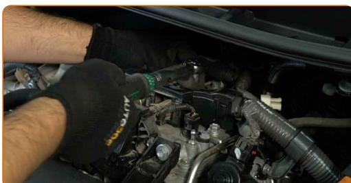
Výměna: zapalovacích svíček - TOYOTA Urban Cruiser (\_P1\_). Doporučují odborníci z AUTODOC:
