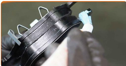
Výměna: brzdové destičky - TOYOTA Yaris Hatchback (\_P13\_). Tip od AUTODOC:
