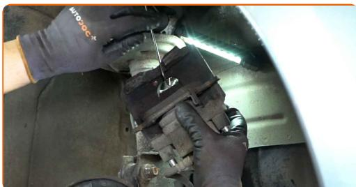
Výměna: brzdové destičky - TOYOTA Yaris Hatchback (\_P13\_). Profesionálové doporučují:
